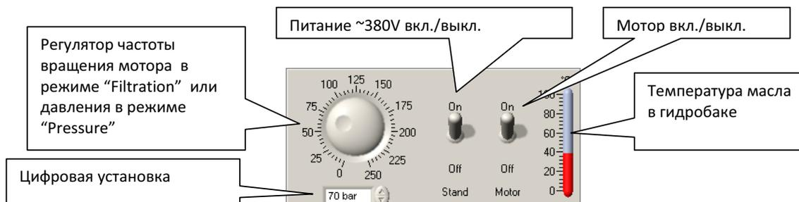
**Рис. 21.** Элементы управления насосной станцией. Включение мотора невозможно, если питание ~380V не включено. Мотор также автоматически выключается при высокой температуре масла.
