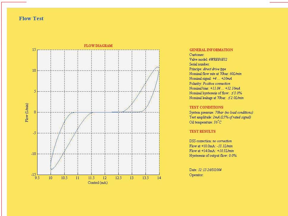
На рисунке слева изображен результат непосредственного измерения статической характеристики клапана фирмы Rexroth. Эта диаграмма сильно "раздута" несмотря на то, что тестирование проводилось достаточно медленно (с частотой 0.01Hz). Такое поведение клапана объясняется наличием встроенной динамической задержки сигнала управления.
