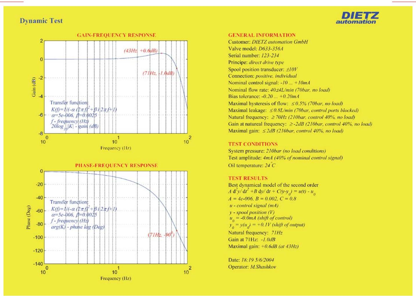
Для построения динамических характеристик достаточно проанализировать сигнал датчика позиции золотника, который пропорционален расходу клапана. Для определения динамических характеристик клапанов без такого датчика фирма DIETZ automation GmbH изготавливает специальный измерительный поршень, который поставляется по желанию клиента.
