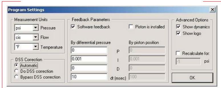
Единицы измерения и диапазон чувствительности каждого виртуального прибора "гидравлической лаборатории" может быть настроен пользователем. Точное цифровое значение любого прибора может быть снято одним щелчком мыши.
