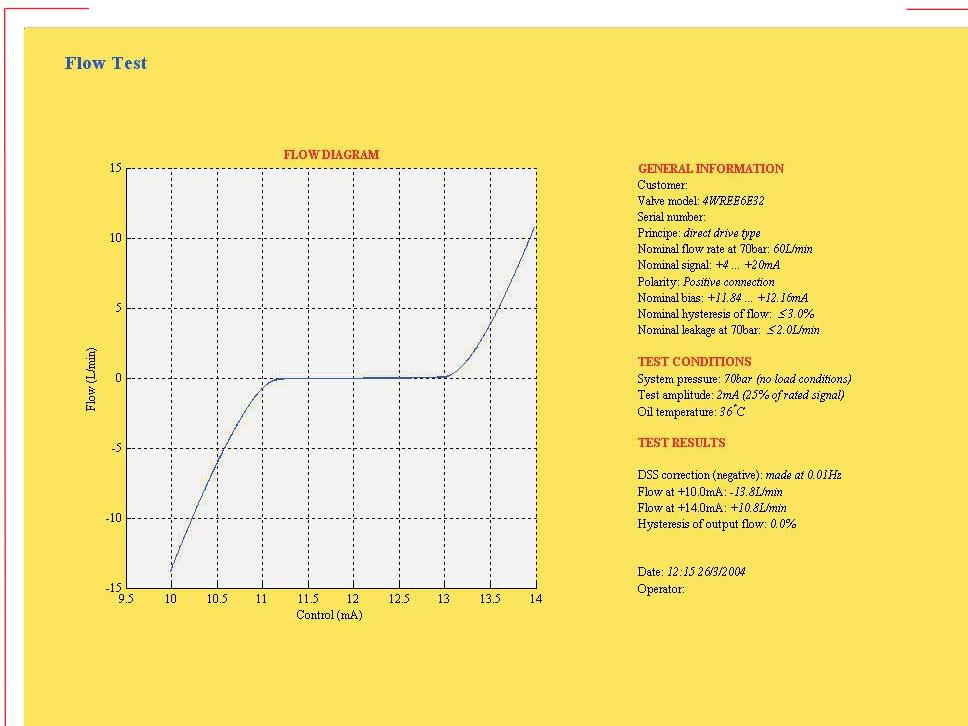
Метод DSS позволяет корректировать динамический эффект, и получить статическую характеристику с высокой степенью точности. Чтобы получить аналогичный результат непосредственным измерением понадобиться более 20 минут. Для этого необходима более мощная насосная станция и водяное охлаждение масла, т.к. энергия, потраченная в результате такого тестирования, будет огромна.
