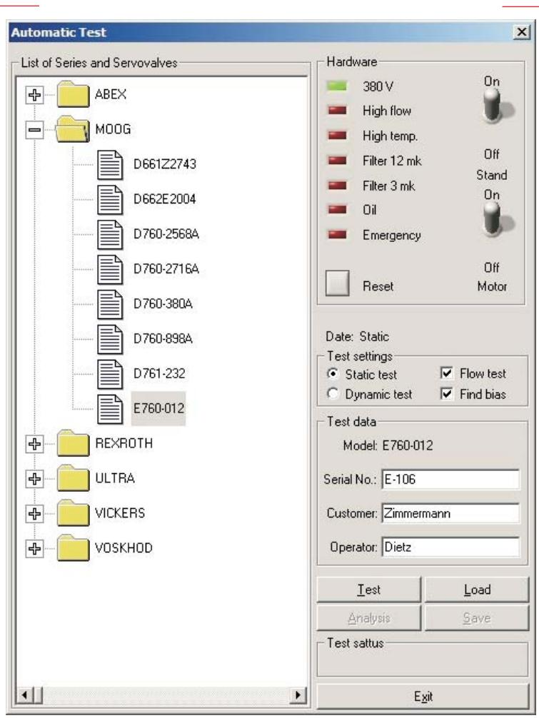
Комплексная проверка клапана осуществляется в автоматическом режиме. Чтобы начать тестирование нужно включить питание стенд и мотор, выбрать клапан из базы данных, установить тип теста и нажать кнопку "Test". При желании также можно заполнить поля: "Serial No.", "Customer" и "Operator". Через несколько минут тест будет закончен и Вам останется только нажать кнопку "Analysis", чтобы получить результаты теста.
