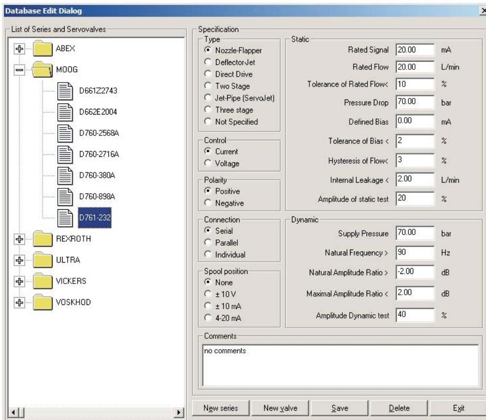
Удобная встроенная база данных серво- и пропорциональных клапанов максимально повышает производительность труда. Все параметры, необходимые для работы, хранятся в этой базе данных и Вам не нужно искать или вспоминать спецификацию клапана, чтобы начать тестирование.
