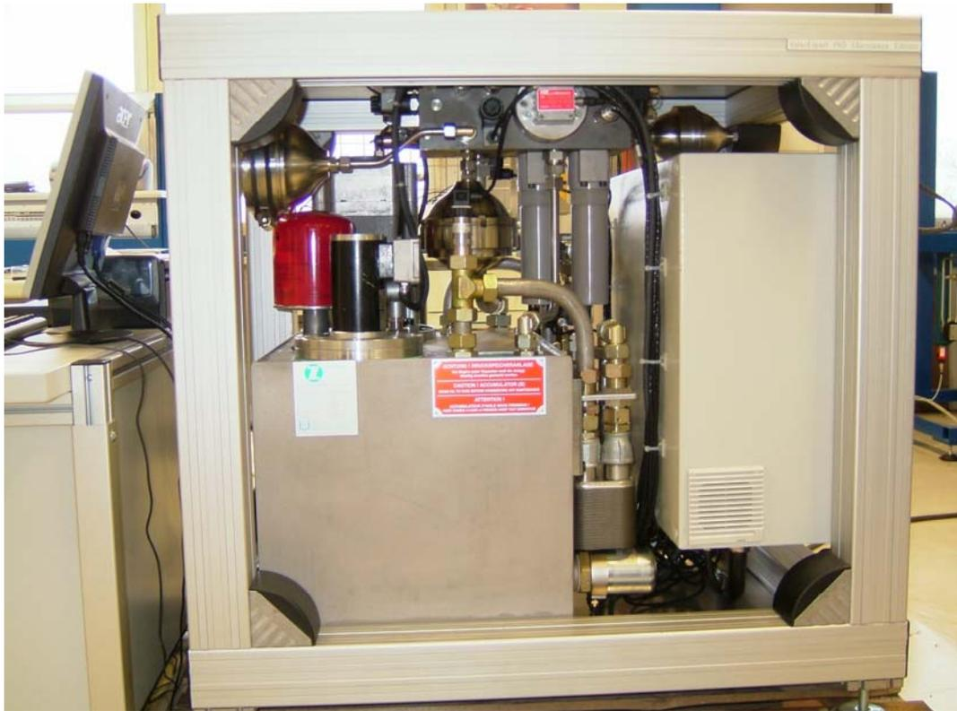
**Рисунок 5.** Бак емкостью 100л, нагреватель и устройство водяного охлаждения дают возможность стабилизировать температуру масла с точностью 1.5С°. В процессе тестирования масло в баке принудительно перемешивается, обеспечивая равномерное распределение температуры.
