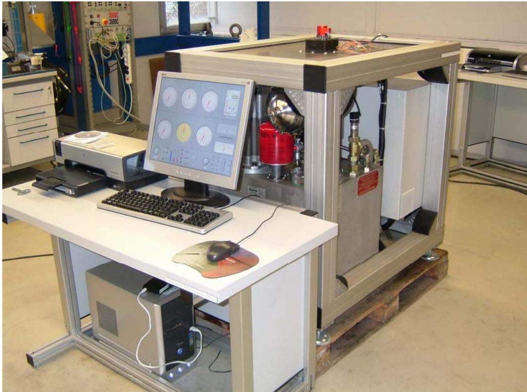
Рисунок 1. Тестовый стенд ValveExpert PRO (Aerospace Edition).
