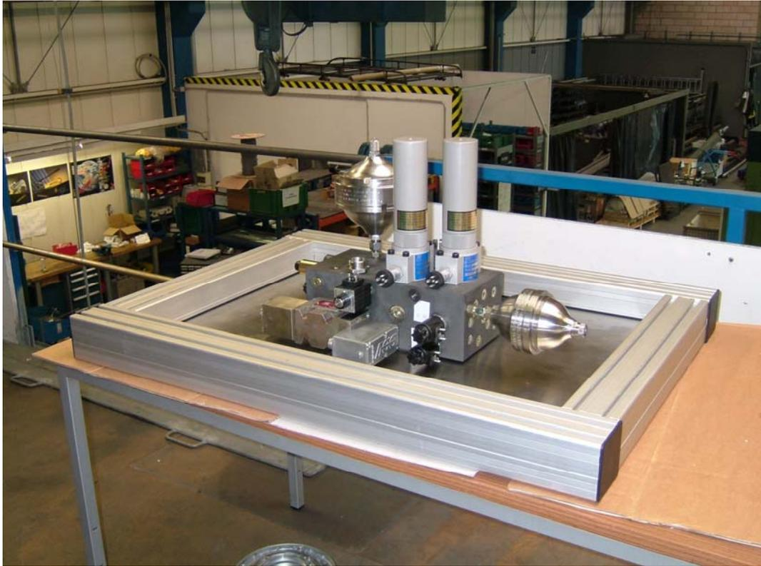
**Рисунок 3. Стенд в процессе сборки. Практически все элементы смонтированы в едином стальном блоке. Такая конструкция исключает аварийную утечку и дает возможность аккуратно измерять динамические параметры клапанов.**
