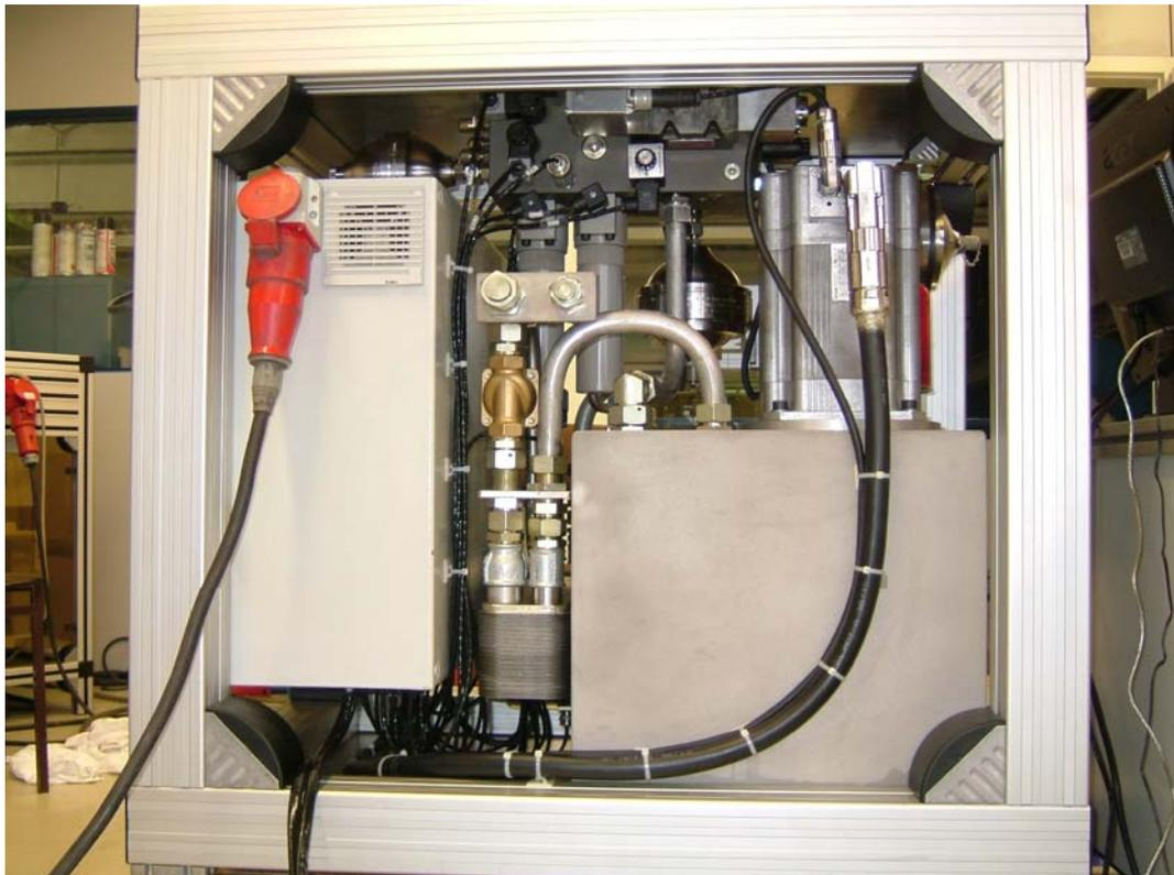
**Рисунок 6.** Сервомотор мощностью 11КВ обеспечивает давление до 250 бар и расход до 40л/мин. В гидравлической станции используется шестереночный насос с рекордно низким уровнем шумов, поэтому шум от стенда минимален.
